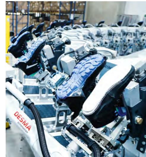
Anfang der 1950er-Jahre waren für die Herstellung von Schuhen noch bis zu 37 Arbeitsschritte nötig: Sohlen mussten aus Gummimatten ausgeschnitten, aufwendig bearbeitet und an den Schaft angepasst werden. Dann gelang DESMA eine Sensation: „Wir haben eine Vulkanisier-Pressen entwickelt, die Sohle und Schaft in wenigen Minuten direkt verbindet“, sagt Geschäftsführer Klaus Freese.
