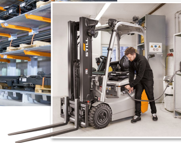
Perfekt für den RX 20 (o.): Lithium-Ionen-Batterien werden unter anderem im meistgekauften Elektrostapler von STILL verbaut. Foto rechts: Die Batterien lassen sich schnell zwischenladen.
