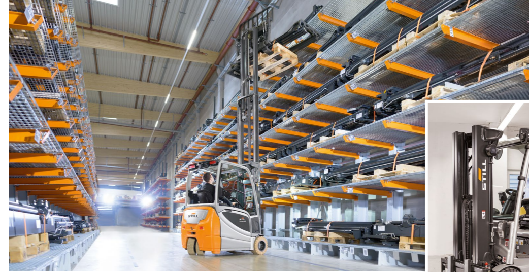
Perfekt für den RX 20 (o.): Lithium-Ionen-Batterien werden unter anderem im meistgekauften Elektrostapler von STILL verbaut. Foto rechts: Die Batterien lassen sich schnell zwischenladen.
