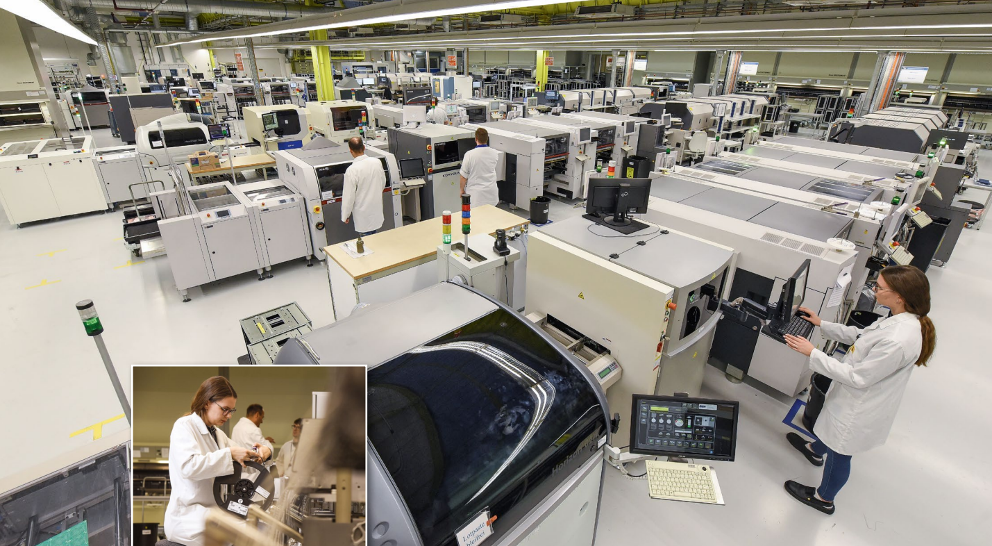
Die smarte Produktion (oben) benötigt eine sorgfältige Vorbereitung des Materials (links). Die elektronischen Elemente für die Platinen werden auf Bänderrollen angeliefert.
