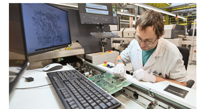
Oben: Leiterplatten werden mit diversen Elementen bestückt. Links: Schichtleiter Daniel Klemckow prüft das Ergebnis.
