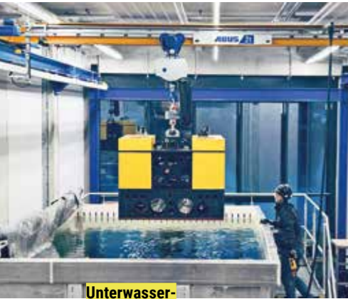
Unterwasser-Hightech: Der modulare Marum Seafloor Lander (MSL) ist ein autonomes Tauchgerät, das die Gabler-Firma Develogic entwickelt hat.
