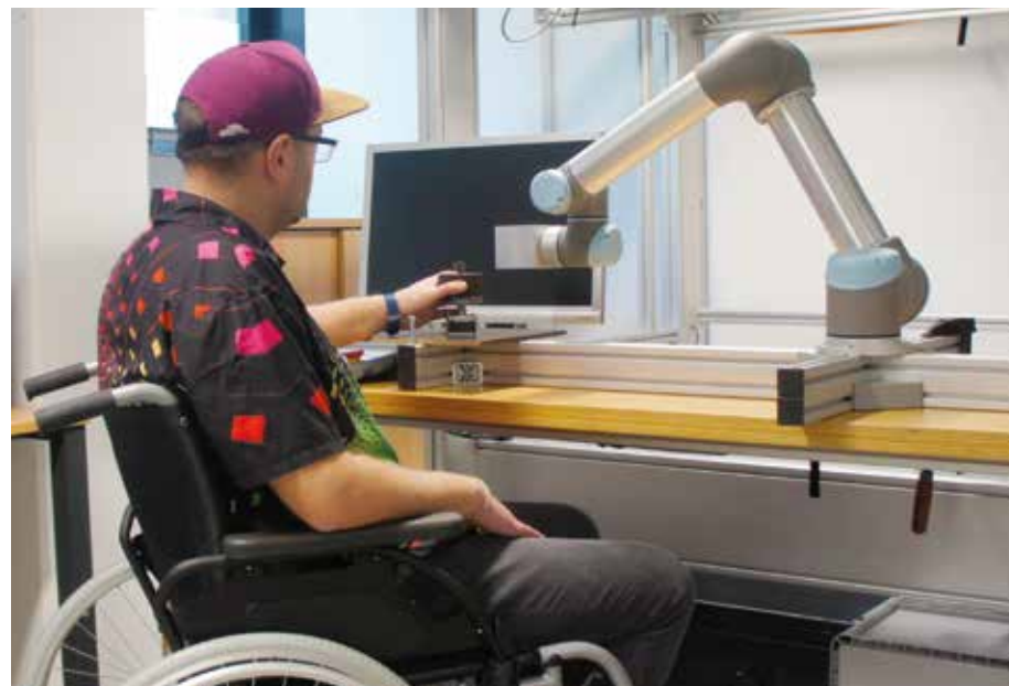
Angewandte Inklusion in der Arbeitswelt: Kollaborative Robotersysteme können dabei helfen, Beschäftigte mit einer Behinderung in die Abläufe von Produktionsbetrieben zu integrieren.
