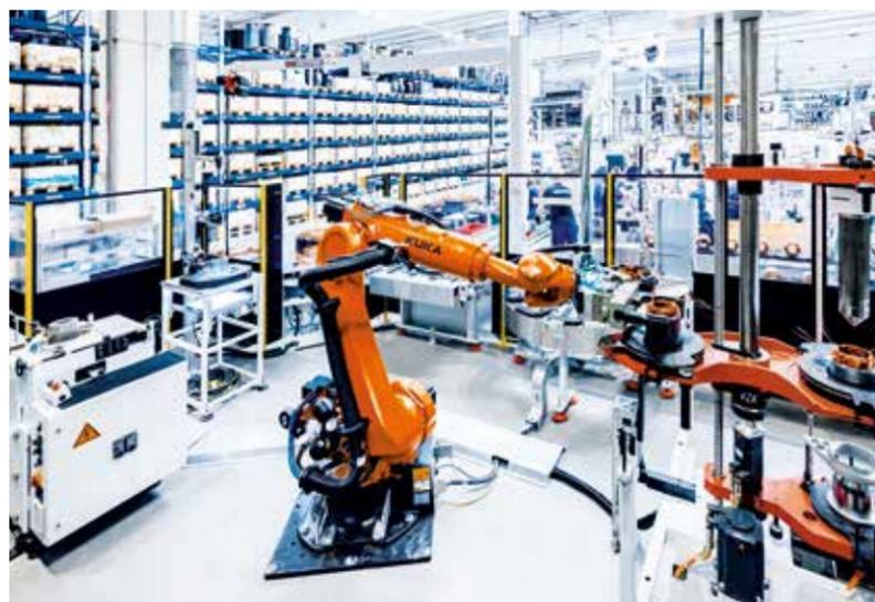
**ROBOTER IM EINSATZ:** Wickelanlage der Motorenfertigung im polnischen Werk Wiechlice.
