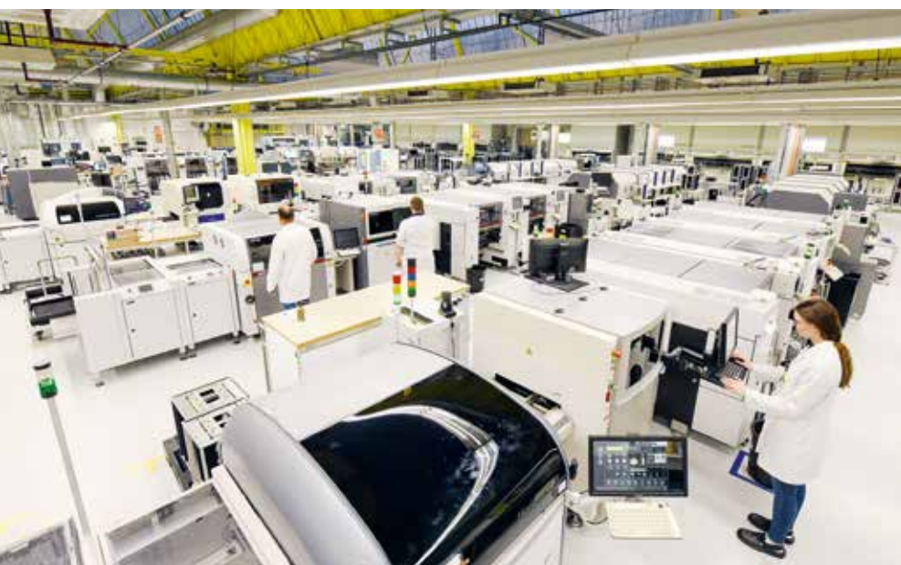
SMARTE MASCHINEN: Die Bestückung der Leiterplatten mit Chips, Widerständen, Kondensatoren und anderen Elementen geschieht weitgehend vollautomatisch.
