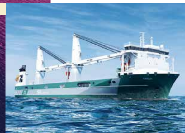
ANIMATION: Zwei Schwerlastkrane vom Typ LS 800 auf einem SAL-Schiff. Jeder kann 800 Tonnen heben.
