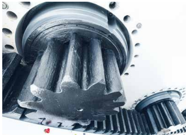
ANTRIEB: Diese Zahnräder helfen, die Drehsäule des großen Krans zu drehen.
