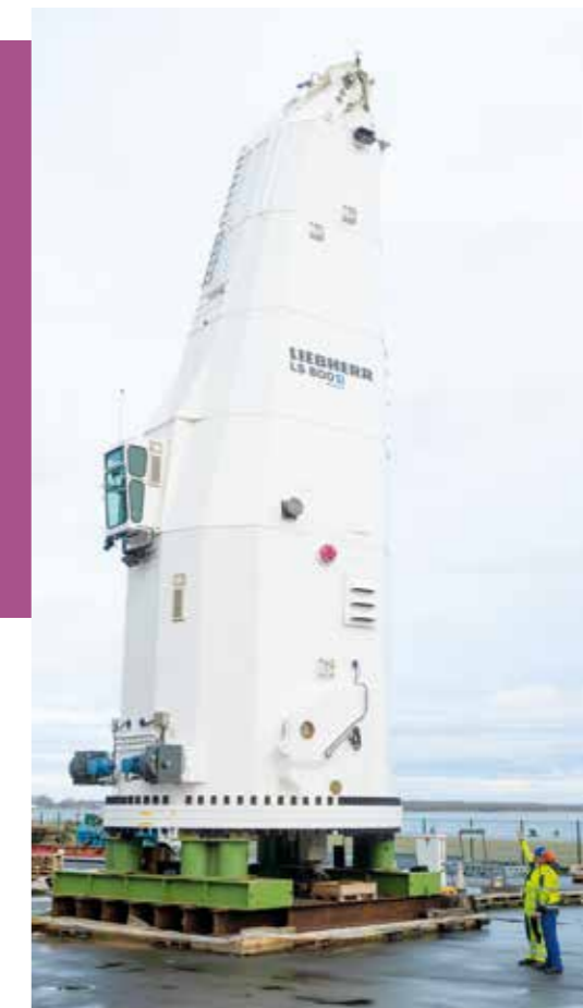
IMPOSANT: Yannick Lüder mit seinem Kollegen Hauke Ahner vor der Drehsäule eines elektrischen Schiffskrans vom Typ LS 800 E.
