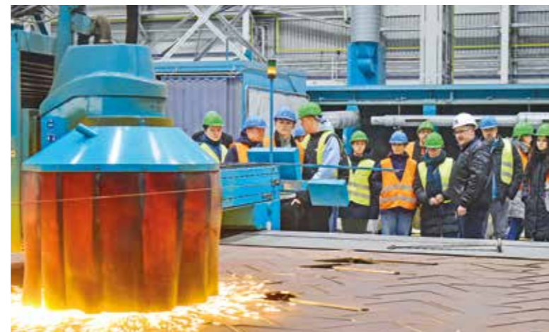
HEISSE SACHE: Die Besucher bestaunen den Brenner, der Stahlplatten voll automatisch und präzise zuschneidet.
