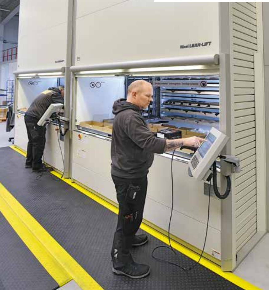
HIGHTECH: Die moderne Liftanlage, an der Logistikleiter Christian Löwe hier steht, kann benötigte Kleinteile automatisch zuliefern.
