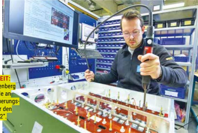
**STRIPPENZIEHER:** Patrick Mohr konfektioniert Kabelbäume für die Elektronik eines Panzers.
