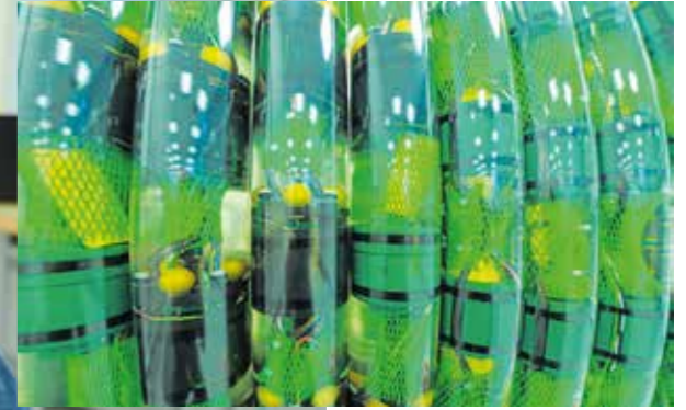
ORTUNGSHILFEN: Die Schleppantennen, die Mirco Riemer hier bearbeitet, sind wichtiger Bestandteil der Sonarsysteme, die Atlas Elektronik entwickelt.
