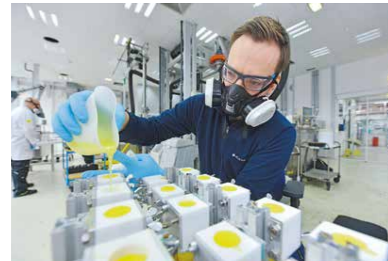
ATEMSCHUTZ FÜR ARBEITSSICHERHEIT: Ein Mitarbeiter versiegelt Bauteile mit einem flüssigen Kunstharz, das später aushärtet.
