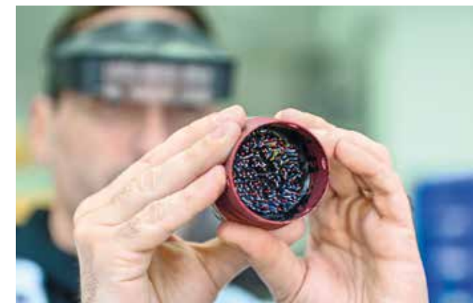
VISUELLE KONTROLLE: Victor Nunes, Teamleiter im Bereich Kabelfertigung, überprüft eine Steckerverbindung.
