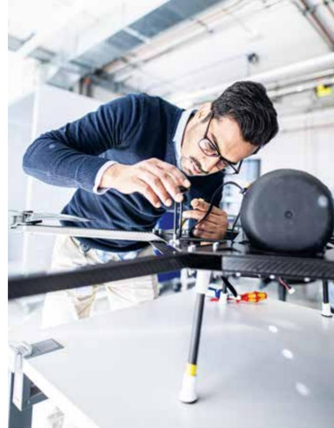
**NACHHALTIG:** Die Drohne, an der hier gearbeitet wird, fliegt mit Strom aus Wasserstoff-Brennstoffzellen.
