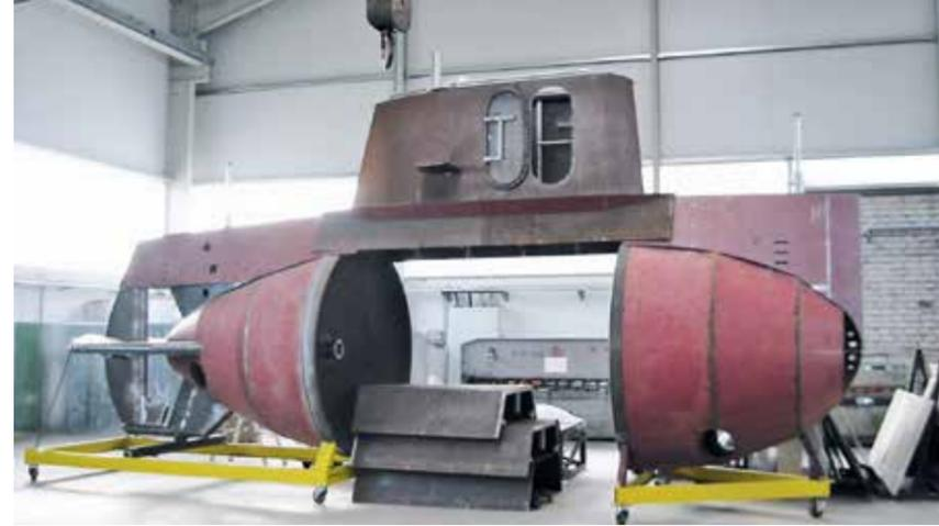
**STAHLBAU:** Die Sektionen für den Druckkörper wurden einzeln gefertigt und dann zusammengesetzt.
