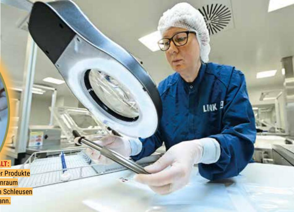
>> Darüber hinaus hat Link innovative Materialien und Oberflächenbeschichtungen entwickelt, denn die Anforderungen an Implantate sind außerordentlich hoch. Willenborg: „Je genauer und glatter die Oberfläche ist, umso weniger Abrieb haben die Gleitflächen der Endoprothese. Das ist ein wichtiges Kriterium für die Lebensdauer.“
