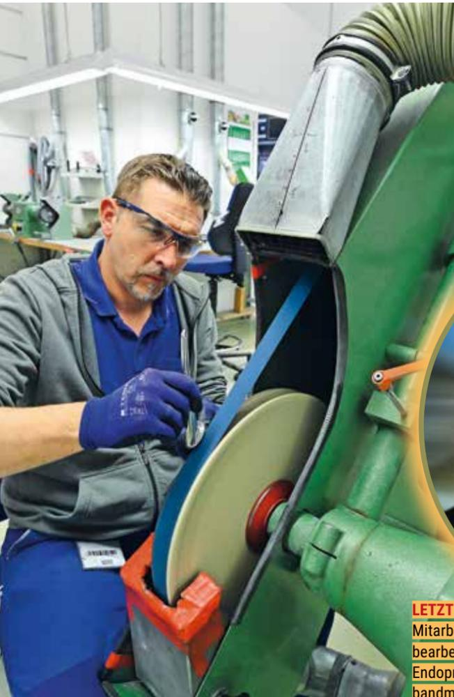
**LETZTER SCHLIFF:** Mitarbeiter Andreas Bein bearbeitet den Schaft einer Endoprothese an der Schleifbandmaschine.
