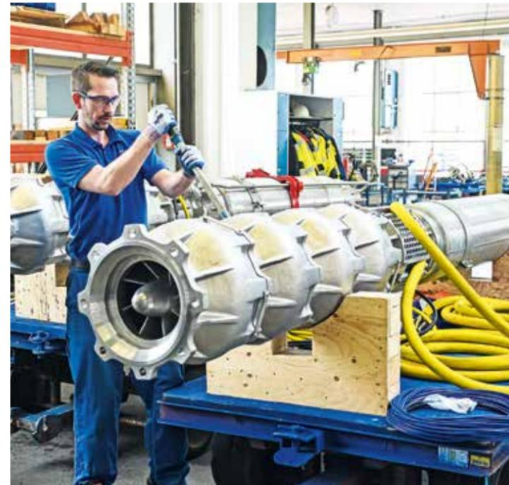
**DER RICHTIGE DREH:** Monteur Ernst Pentzien zieht Muttern an einer Pumpe für Offshore-Windkraftanlagen fest.
