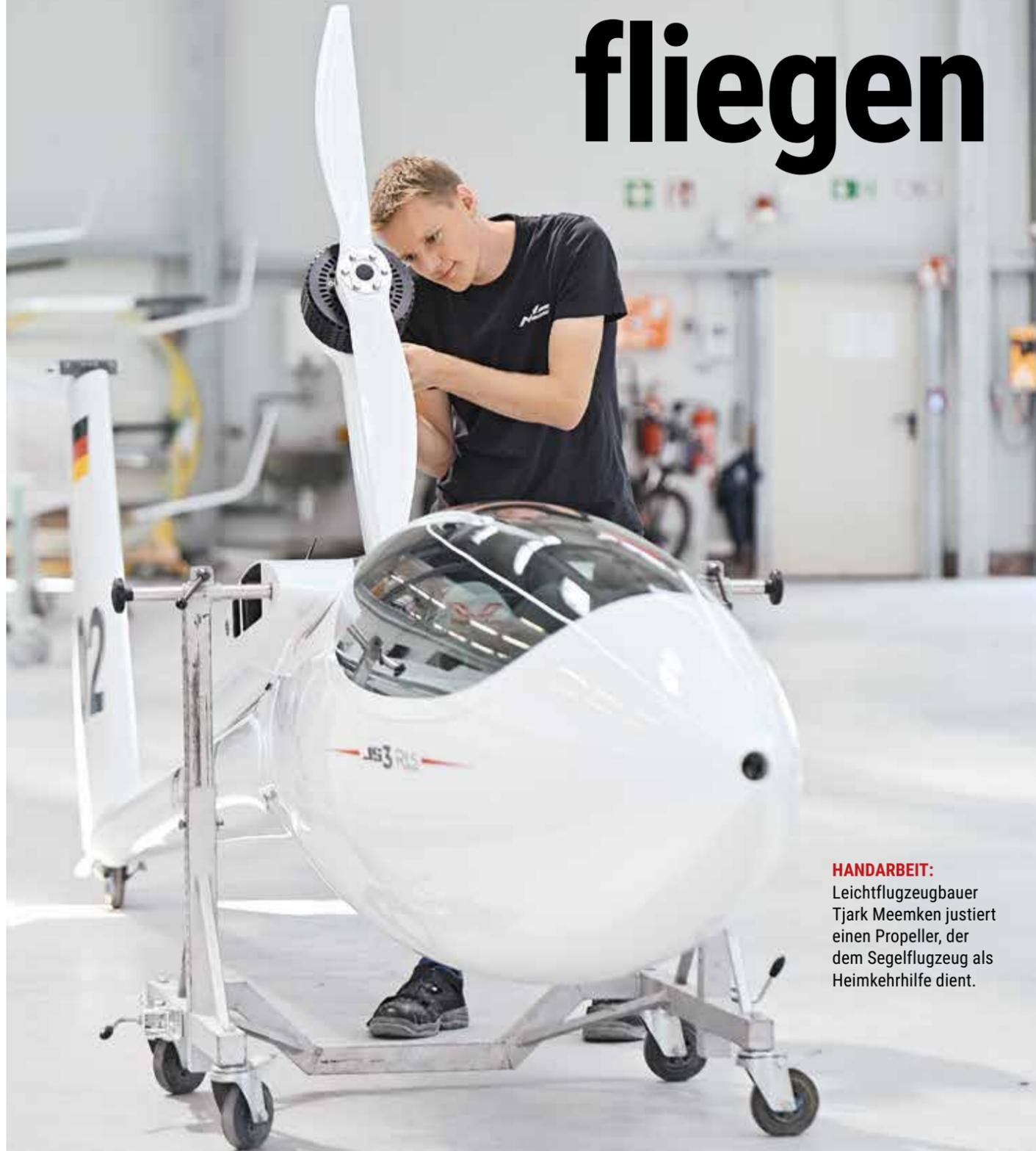
**HANDARBEIT:** Leichtflugzeugbauer Tjark Meemken justiert einen Propeller, der dem Segelflugzeug als Heimkehrhilfe dient.
