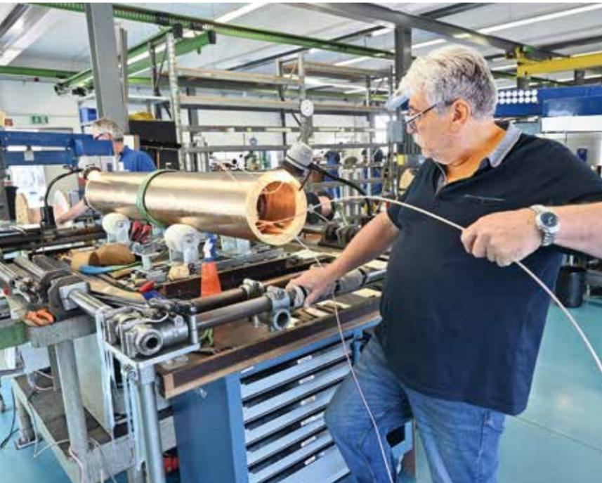
**HOHE FERTIGUNGSTIEFE:** Die Pumpenmotoren und andere Bauteile werden bei Pleuger nicht zugekauft, sondern in aufwendiger Handarbeit selbst gefertigt.
