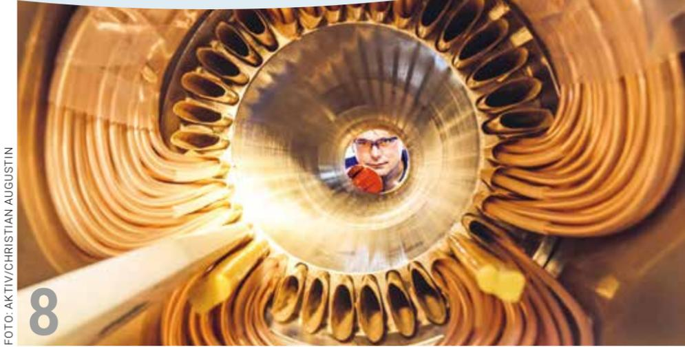
**MARKEN-PRODUKTE:** Die Pumpen der Hamburger Firma Pleuger sind eine Klasse für sich. Sie werden von einem wassergefüllten Unterwassermotor angetrieben.
