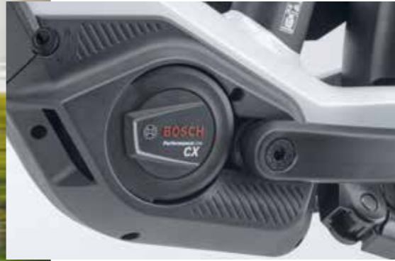
ANGENEHM: Beim Mittelmotor ist das Rad gut ausbalanciert.
