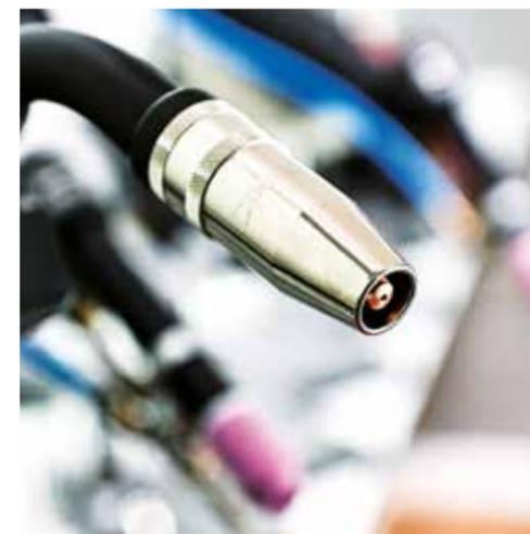
**FERTIG ZUM EINSATZ:** Düse eines modernen Schutzgas-Schweißgeräts aus Norderstedt.
