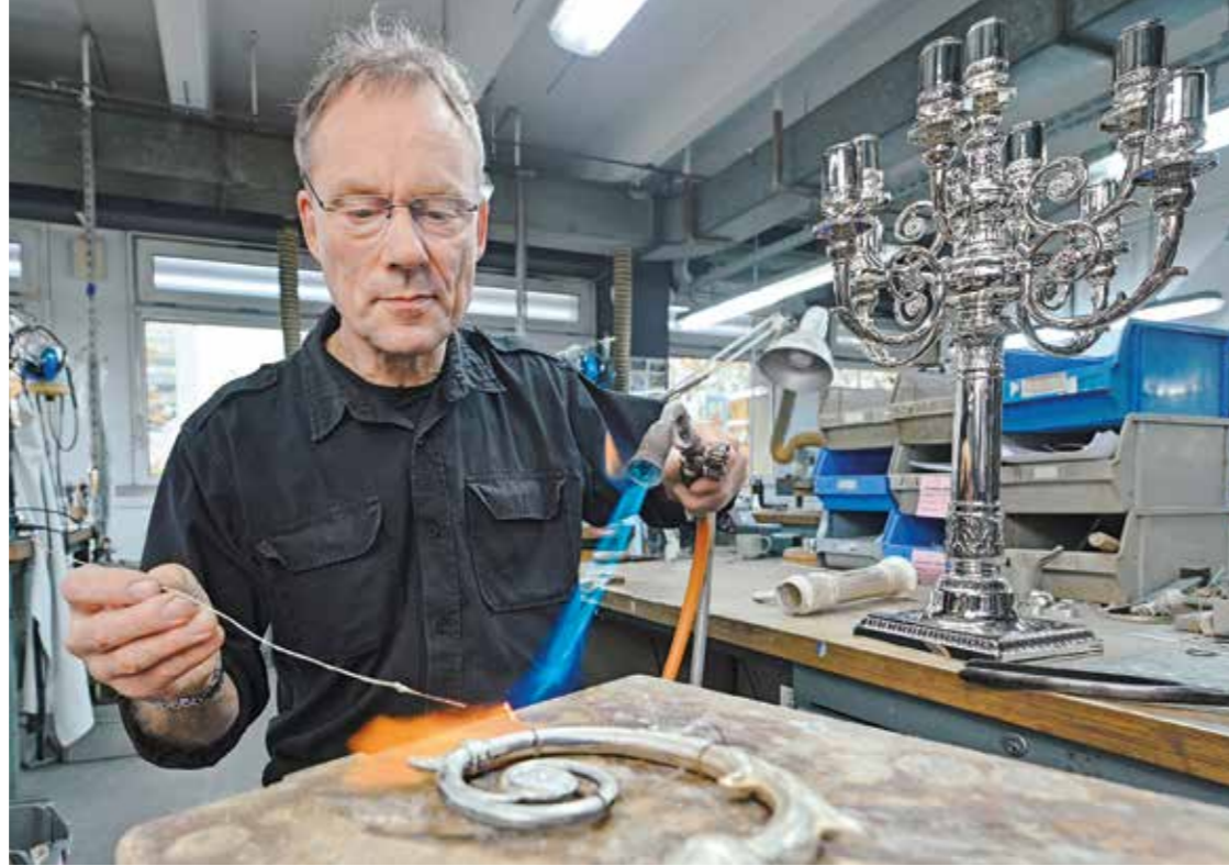
RUHIGE HAND: Martin Koschnick lötet einen Leuchter, der aus über 105 Einzelteilen besteht.
