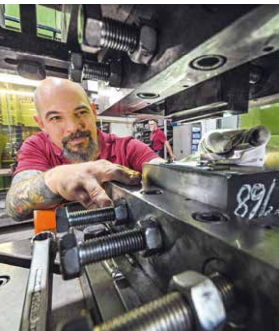
AN DER PRESSE: Aus dem Rohling, den Marco Wietek hier einlegt, wird später eine Gabel.
