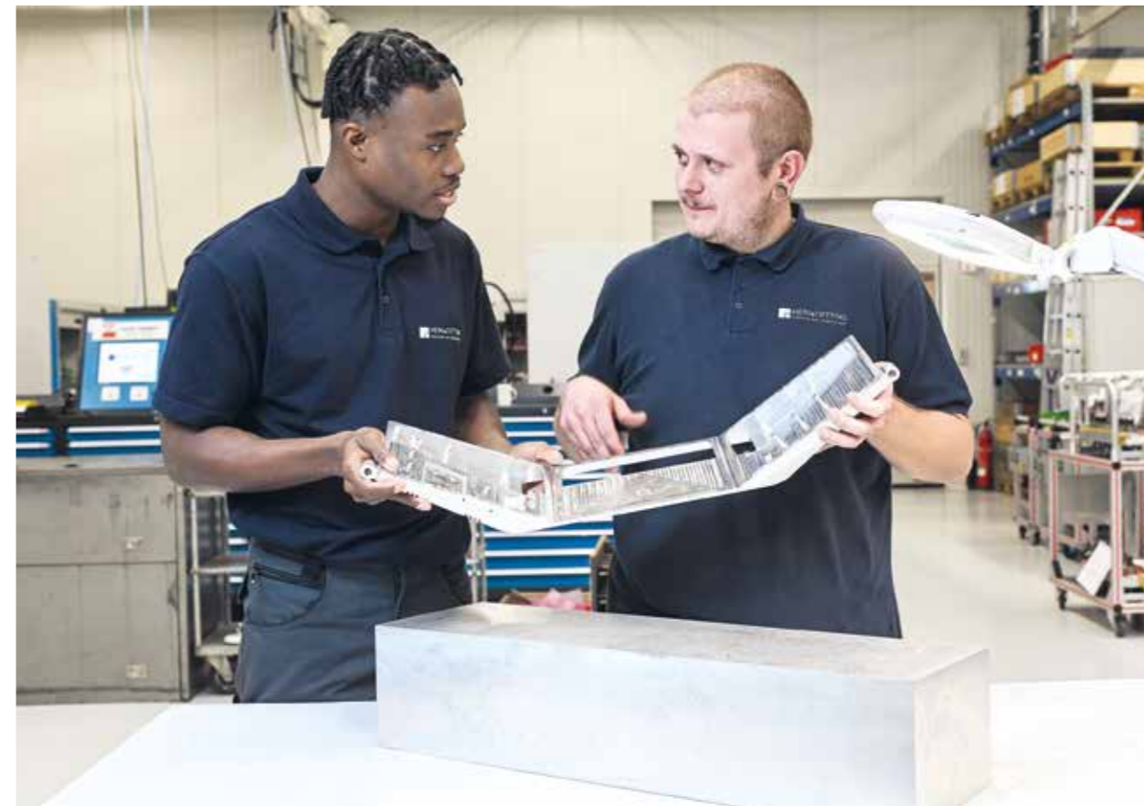
AUS EINEM STÜCKGEFRÄST: Die Halterung, die Ausbilder Sascha Stein (linkes Bild, rechts) seinem Azubi Roland Saizonou erklärt, wird aus einem 60 Kilo schweren Alublock gefräst.
