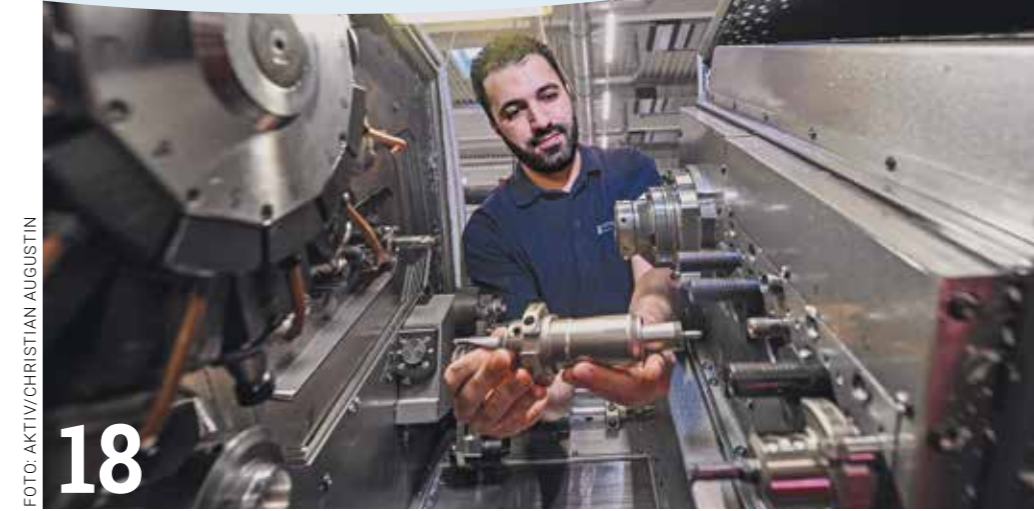
ZUPACKEND: Mohammad Yousef beim Werkzeugwechsel an einer CNC-Anlage. Er arbeitet in der Metallfirma Hein & Oetting, dort geht es in der Fertigung um tausendstel Millimeter.
