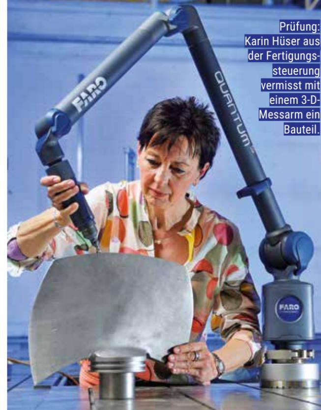
Prüfung: Karin Hüser aus der Fertigungssteuerung vermisst mit einem 3-D-Messarm ein Bauteil.
