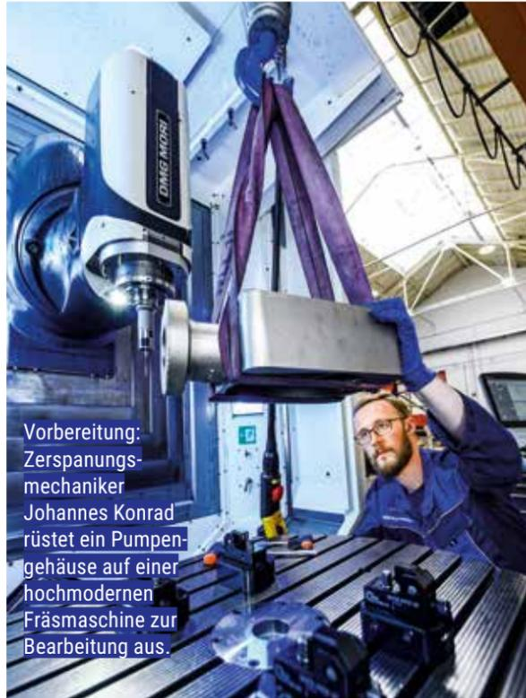
Vorbereitung: Zerspanungsmechaniker Johannes Konrad rüstet ein Pumpengehäuse auf einer hochmodernen Fräsmaschine zur Bearbeitung aus.
