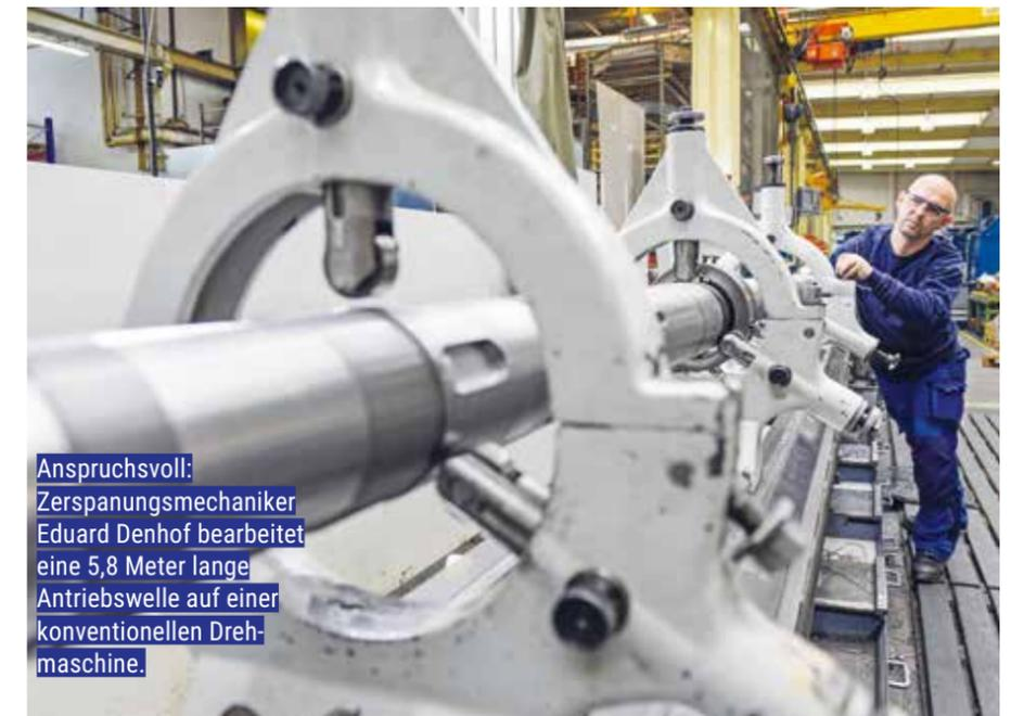
Anspruchsvoll: Zerspanungsmechaniker Eduard Denhof bearbeitet eine 5,8 Meter lange Antriebswelle auf einer konventionellen Drehmaschine.
