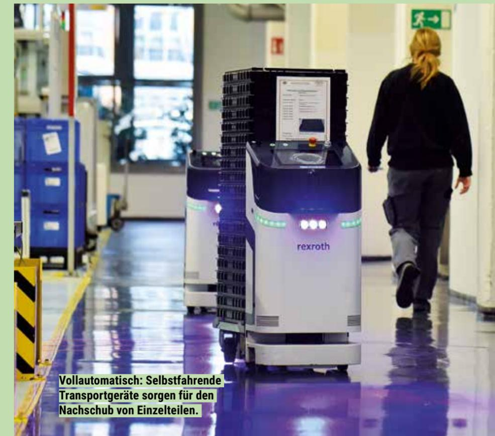
Vollautomatisch: Selbstfahrende Transportgeräte sorgen für den Nachschub von Einzelteilen.
