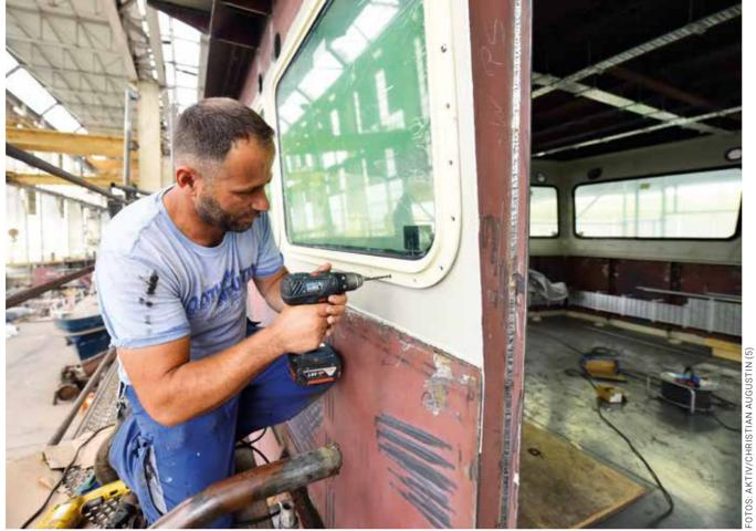
**ARBEITEN AM STEUERHAUS:** Ein Mitarbeiter setzt die Bohrlöcher für die Fenster des Deckshauses, das später als fertiges Modul auf das Planierschiff gehoben wird.
