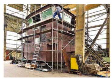
**LETZTE HANDGRIFFE:** Das Deckshaus der "Chicago" wurde in einer anderen Ecke der großen Hitzler-Halle gesondert montiert und erst nach der Fertigstellung mit dem Planierschiff "verheiratet".
