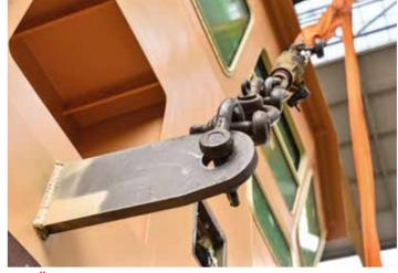
**AUFHÄNGUNG:** Um den schweren Decksaufbau mit dem Kran auf den Schiffsrumpf heben zu können, wurden vorher Laschen angeschweißt.
