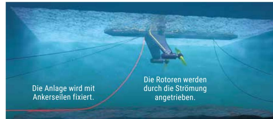
Die Anlage wird mit Ankerseilen fixiert.
