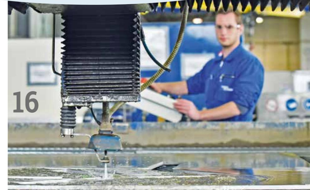
**16 FERTIGUNG BEI TURBO-TECHNIK:** Der Mittelständler arbeitet mit hochmodernen Maschinen wie dieser Wasserstrahlschneidanlage, die selbst zentimeterdicke Bleche präzise schneidet.
