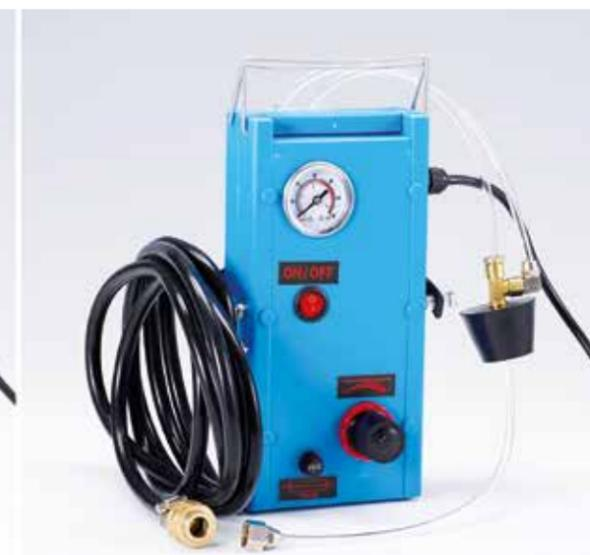
**LEBENSGEFÄHRLICHER NACHBAU:** Die Verkabelung dieses kopierten Bremsenentlüftungsgeräts (rechts) ist nicht fachgerecht. Das Original (links) kommt von der Firma Manotec.
