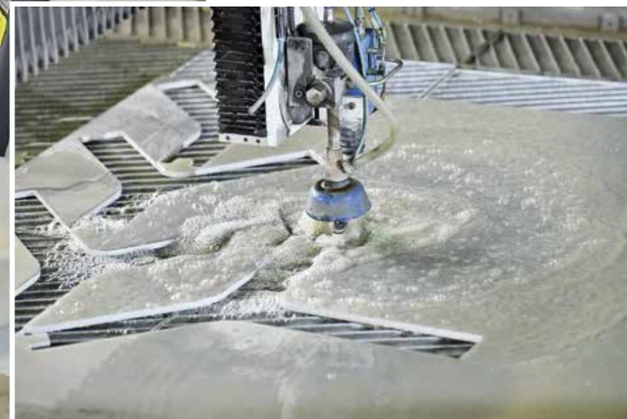
**MIT WASSERKRAFT:** Diese Anlage schneidet sogar Bleche mit 200 Millimeter Dicke.
