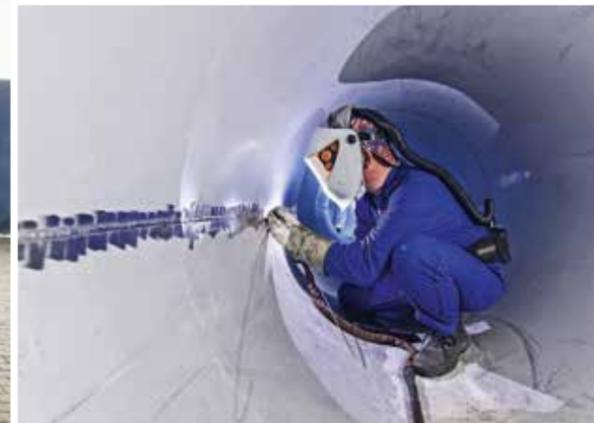
**ABGASSTRANG:** Die Bleche werden erst auf der Biegemaschine geformt und dann zusammenschweißt.
