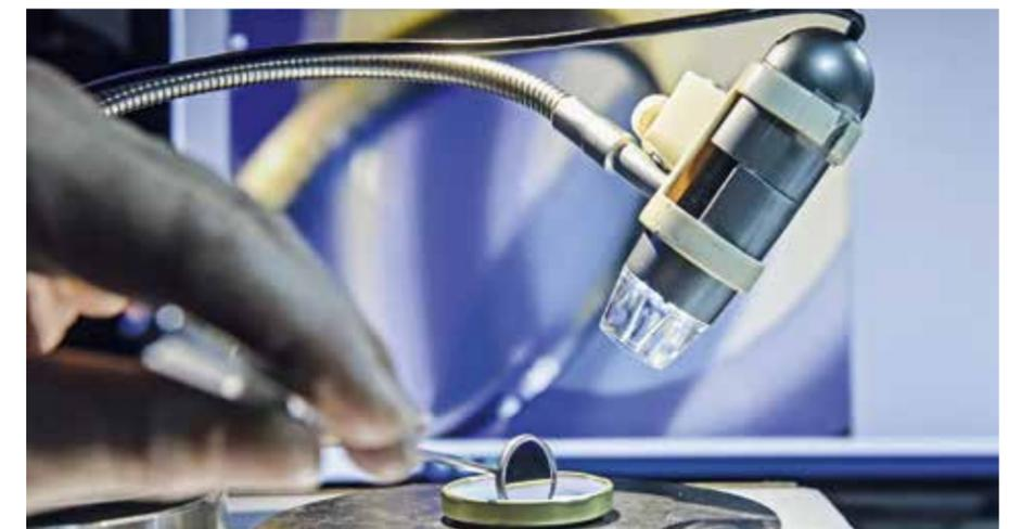
**WICHTIGES DETAIL:** Mit einem kleinen Spiegel wird überprüft, wie der Verschluss unter dem Rand aussieht.
