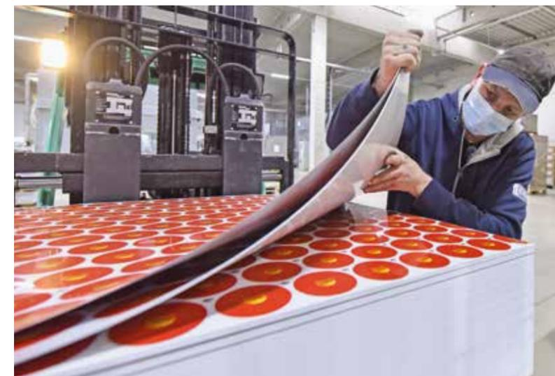
**ZWISCHENPRODUKT:** Nach dem Lackieren und Bedrucken werden die Bleche kontrolliert und zur Verschlussproduktion bereitgestellt.
