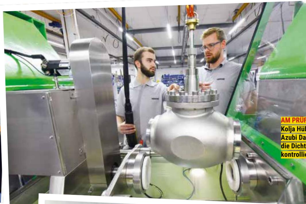
**AM PRÜFSTAND:** Kolja Hübscher (rechts) zeigt Azubi Daniel Darst, wie die Dichtigkeit von Ventilen kontrolliert wird.
