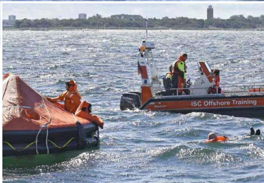
**RETTUNGSINSEL:** Die runde Konstruktion lässt sich im Notfall innerhalb von Sekunden aufblasen.
