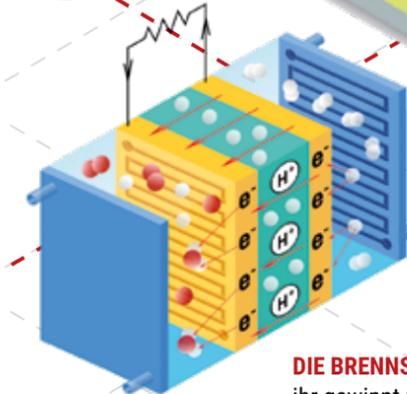
**DIE BRENNSTOFFZELLE:** Mit ihr gewinnt man aus Wasserstoff Strom und Wärme. Als Nebenprodukt wird dabei Wasser freigesetzt, aber kein Abgas.
