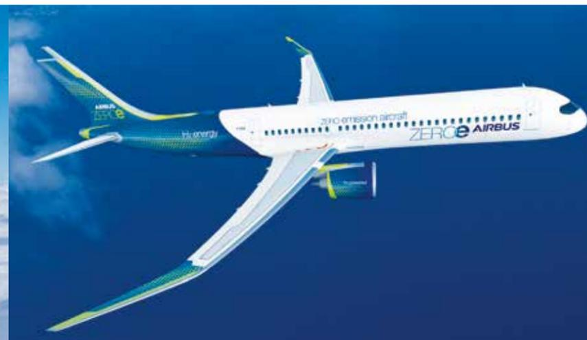
**KONZEPT TURBOFAN:** Das Modell hat ein modifiziertes Gasturbinentriebwerk, in dem statt Kerosin Wasserstoff zum Einsatz kommt. Das flüssige Gas wird in Tanks untergebracht, die sich hinter dem hinteren Druckschott befinden.
