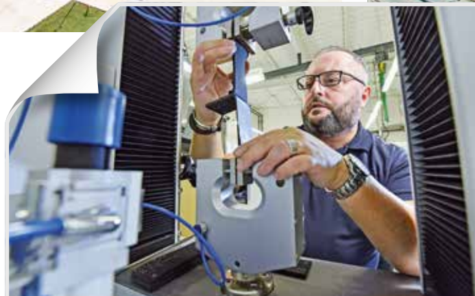
FESTIGKEITSPRÜFUNG: Witold Cygan spannt zwei miteinander verschweißte Streifen aus Synthesekautschuk in die Zugprüfmaschine.
