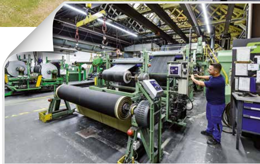
HEIMISCHE FERTIGUNG: Die EPDM-Bahnen des Unternehmens werden in Deutschland hergestellt. Hier ein Blick in die Produktion des Werks im Hamburger Süden.
