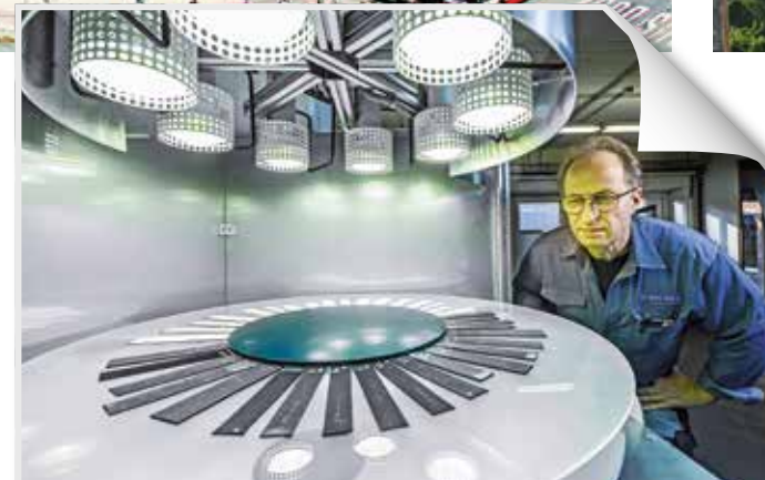
WETTERTEST: Meister Robert Schreiber vor einem Apparat, in dem Proben teilweise jahrelang mit intensivem UV-Licht bestrahlt werden.
